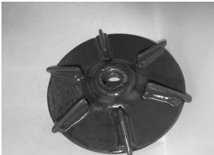
Рис. 7.3. Защита из Ф – 2М рабочего колеса насоса.
